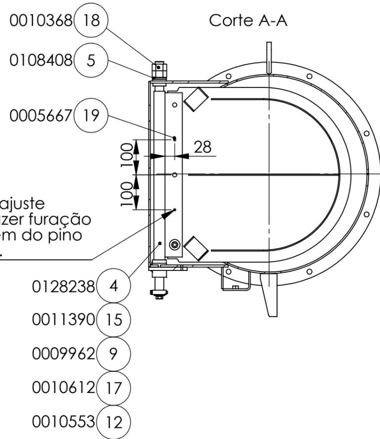
Nota: Realizar ajuste da tampa e fazer furação para montagem do pino elástico (5667).
